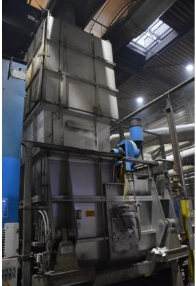
StrikoWestofen MH II-T<br><b>2000/1500 G-eg four de fusion et de maintien</b><br><b>O1848, utilisé</b><br>Réf. produit : O1848 | <b>1,00 €</b> |
