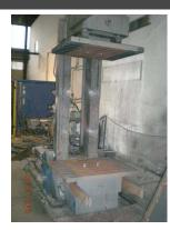
Machine de coulée par gravité basculante Kurtz AK01, usagée
